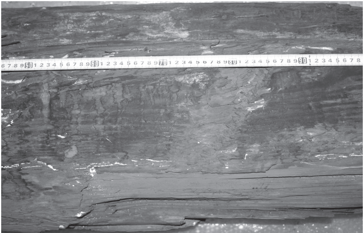
Figure 7.9 火熱による一部炭化箇所 (写真: 柏木)。
